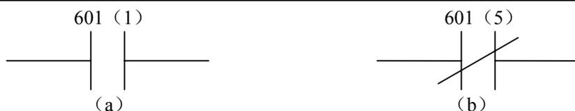
(a) 接点表示当 601 计数值为 1 时，该接点接通，(b) 接点表示当 601 计数值为 5 时该接点断开，当计数值不是 1 时，(a) 接点总是断开的，当计数值不是 5 时，(b) 接点总是接通的，把它们写成语句时，一定要注意不能在 601 之前写“CNT”，同时要在后面写出步数。用这方法来表示计数器的一种特殊用法，以区别于计数器线圈的接点。
